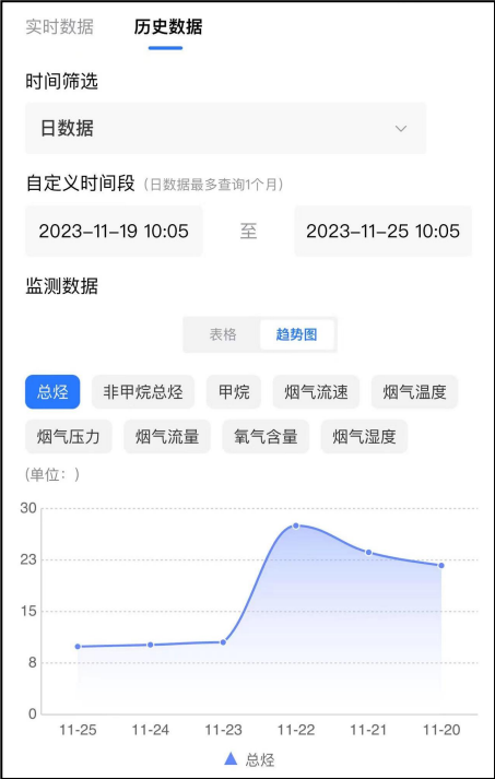
图 2-10 有机废气沸石转轮设施更换前后有机废气排放在线监测数据 (11 月 23 日开始运行，以总烃表征)
